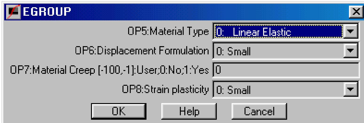
Proprietățile de material ce trebuie precizate în cazul unei analize structurale sunt E și v
