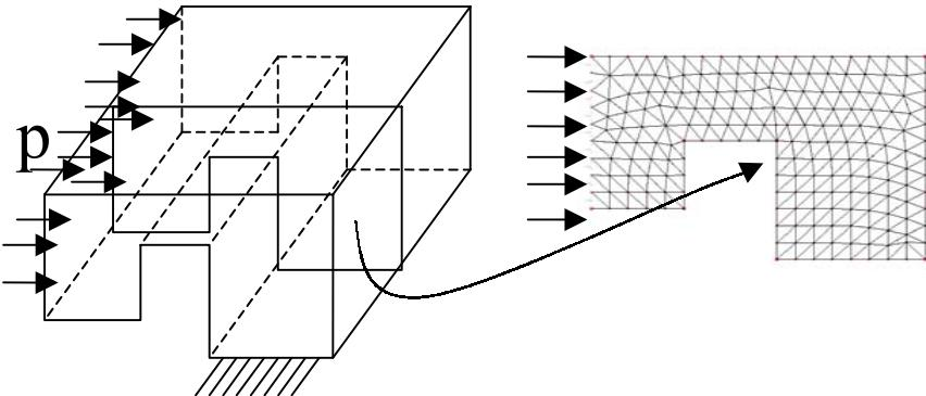
Structură cu lățime mare, pentru care se poate considera că deformația și solicitarea este identică în toate secțiunile transversale
