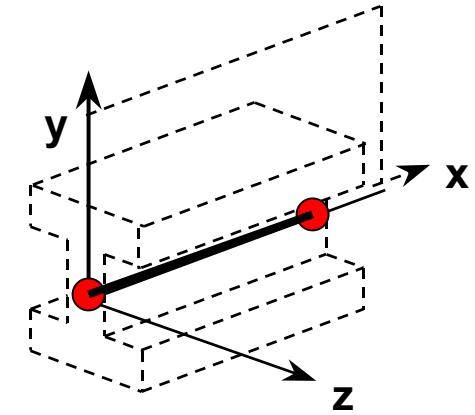
Element grindă cu 2 noduri (tip linie) - beam
