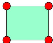
Element de solid de revoluție cu încărcare axial-simetrică
