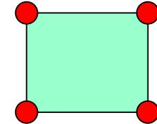
Element de stare plană de deformații cu 4 noduri (tip suprafață) - quad -Plane2D
