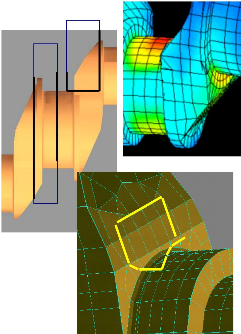
**Persistă probleme pentru analiza modelelor de tip solid: un exemplu concret - arborele cotit**
