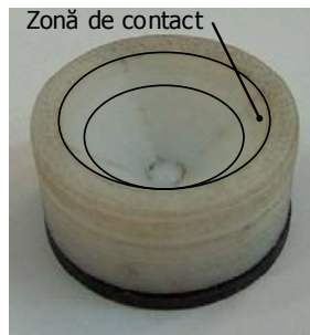
Figura 18 Piston pentru preluarea șocului
